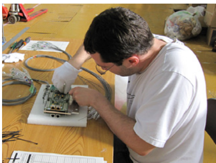
図 8.6 TFB へのケーブルの取り付け
