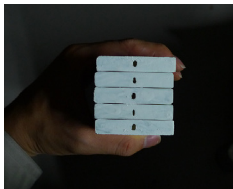
図 E.9 端面に反射材を塗布したシンチレータ
