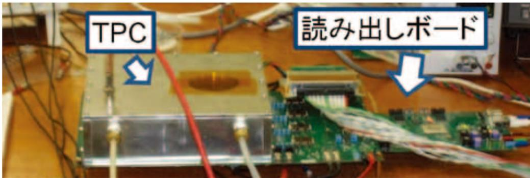
現段階のQpixチップは機能確認のために16チャンネル/chipで製作され、テストのために全ての入力が入力パッドに接続されている。よって直接読み出しパッドとして使用することができないため今回のシステムテストではドリフトする電子をGEMによって増幅し、ガス雰囲気中の基板上ピクセル電極によって受け、基板配線によってQpixチップに接続されている。2009年にはアレー状に配置されたQpixを試作する予定である。
