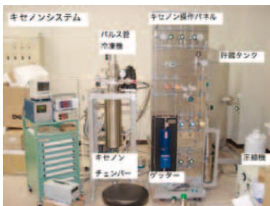
図 2: 液化・純化システムの写真
