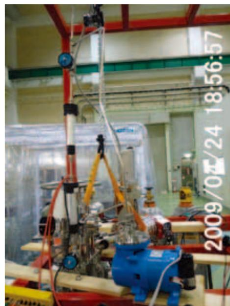
図2；循環系。青いポンプとフィルター回りのSUS管で循環する。
