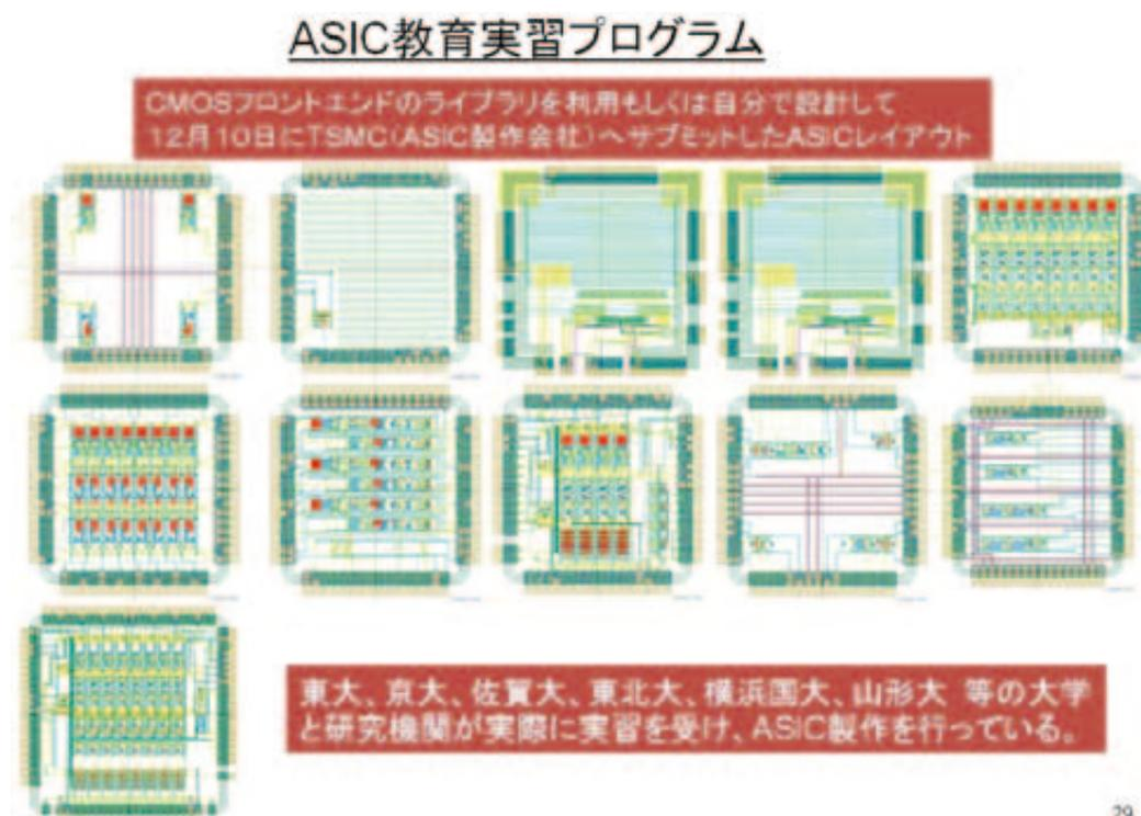
図 6-1 ASIC 教育実習プログラムによるサブミットチップのレイアウト
