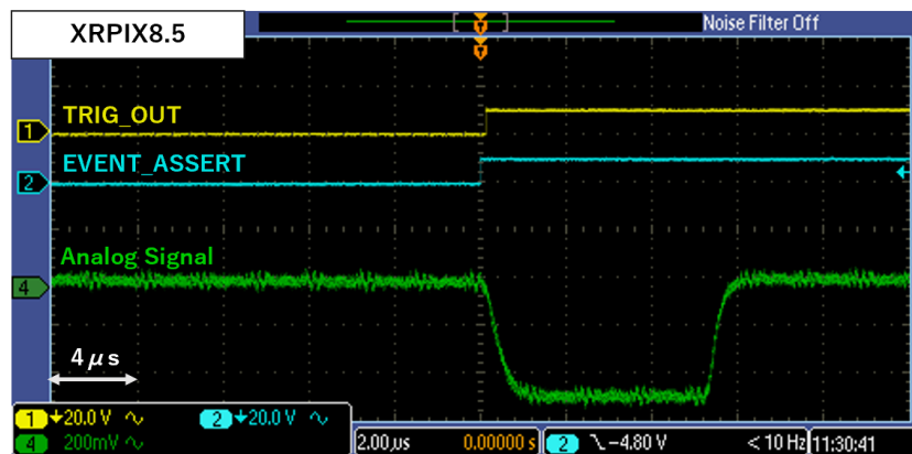
図 4.3 \Delta V_{TH}=80 mV の条件で取得した XRPIX8.5 での ^{109}\text{Cd} の X 線入射時のアナログ信号と各制御信号の波形。黄は TRIG_OUT、青は Event_Assert、緑はアナログ信号を表す。
