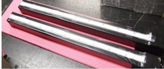
BGOシンチレーション結晶 ( $30 \times 25 \times 400 \text{ mm}^3$ )
