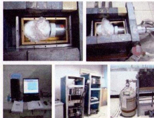
測量低本底材料放射性的探測器
