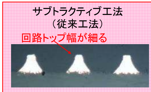
高密度回路の断面形状比較(開発試作品の例)
