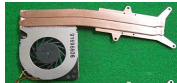
Heat Pipe Thermal Module
